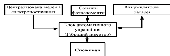
Рис. 1. Принципова схема структури гібридної СЕР / Principal scheme of the hybrid power supply system structure
