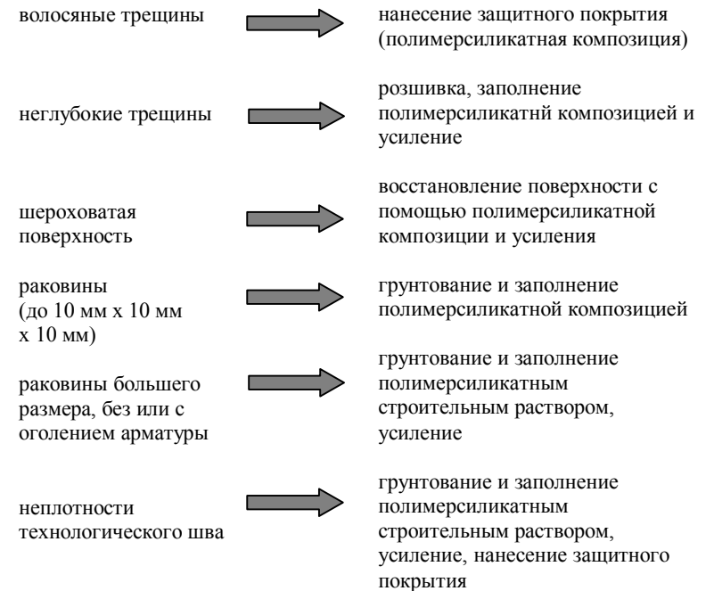
Рис. 1. Схема восстановления поврежденных и дефектных мест.
