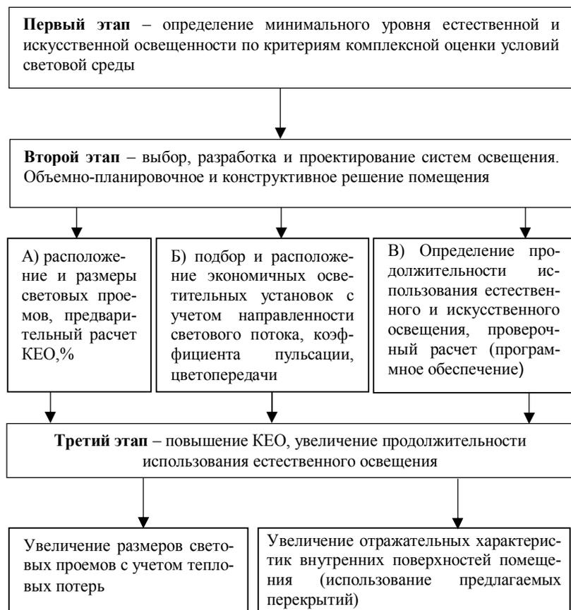
Рис.3. Схема поэтапного расчета естественного освещения для формирования комфортной световой среды.
