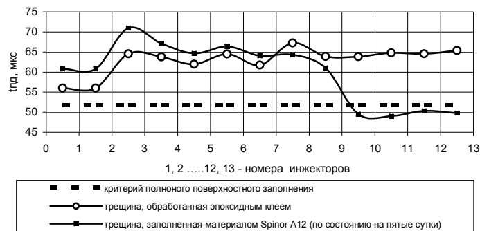
Рис. 2. Характер распределения значений информативного параметра по длине трещин в стенах модулей
