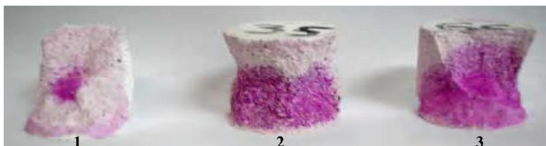
Рис. 1. Изменение толщины карбонизированного слоя известковых образцов в зависимости от формовочной влажности известкового теста (время карбонизации 10800 с), % мас.:
