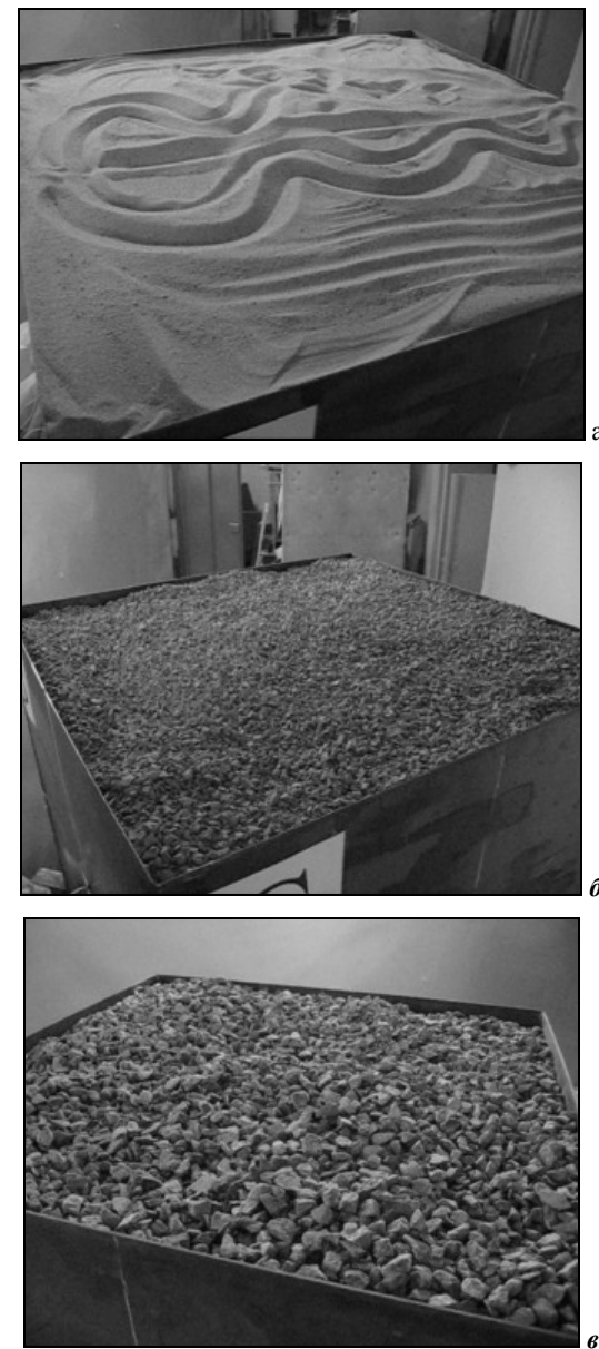
Рис. 6. Пробная загрузка емкости сыпучими материалами: а) песком, б) мраморной крошкой, в) щебнем.
