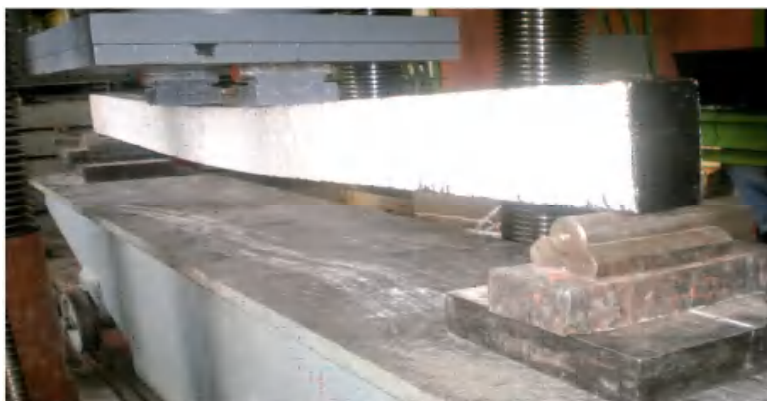
Рис. 4. Характер деформування балок
