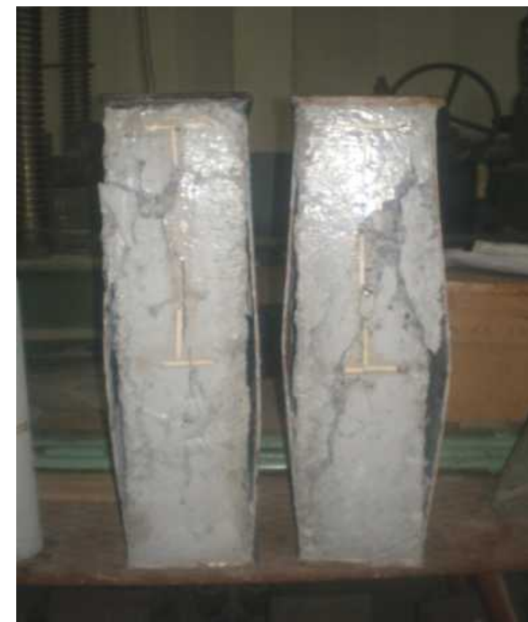
Рис. 5. Характер руйнування дослідних зразків – призм
