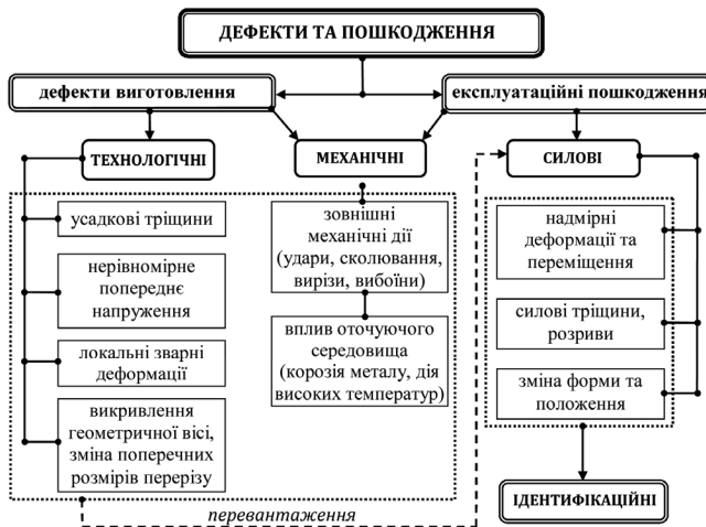
Рис. 1. Класифікація дефектів та пошкоджень будівельних конструкцій
