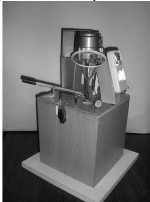
Рис. 1. Загальний вигляд калориметричної установки
