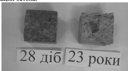
Рис. 1 Глубина карбонизации бетона образцов разного возраста
