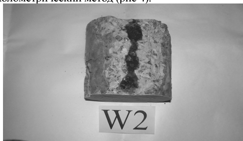
Рис. 4 Определение глубины карбонизации путем нанесения 1% раствора фенолфталеина на скол цилиндра.
