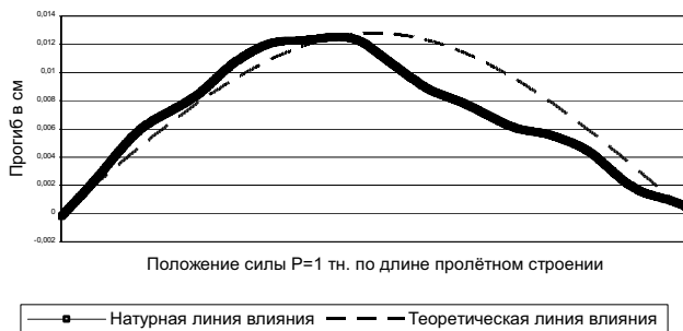
Рис. 2. Натурная и теоретическая линии влияния прогиба середины железнодорожного пролётного строения l_p = 33.5 \text{ м}
