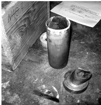
Рис. 2. Загрузка шихты из стали 110Г13 в алундовый тигель
