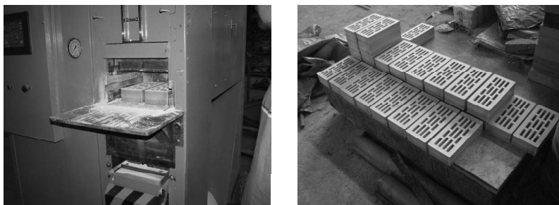
а б Рис. 3. Процесс формования (а) и вид полученного кирпича (б)
