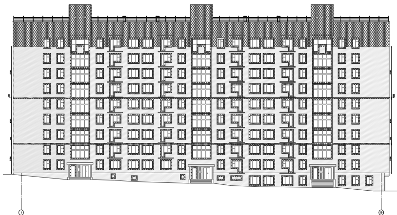
Рис. 1. Фасад жилого дома по ул. Погребняка, 18 в г. Днепропетровске. Раскладка плит утеплителя, устройство противопожарных ярусов и окантовка оконных и дверных проемов в системе наружного утепления
