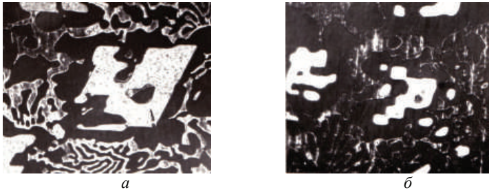
Рис. 3. Микроструктура сплава Fe-B-C:
