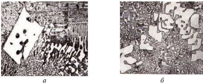
Рис. 2. Микроструктура сплава системы Fe-B, наплавленного в присутствии низкочастотных колебаний с частотой 100 Гц:
