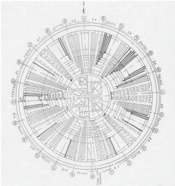
Рис. 6. Схема вышедших их строя канатов
