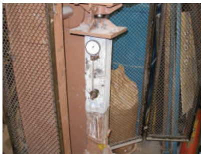
Рис. 5 Призма в специальной установке при длительных испытаниях
