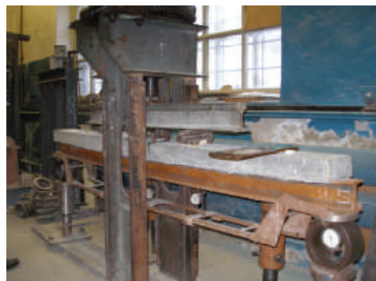
Рис. 2 Балка в прессе с установленными приборами
