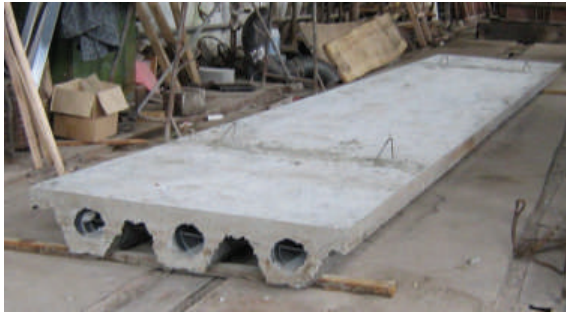
Рис. 4. Пустотноребристая плита размером 1,0 х 6,0 м после изготовления и распалубки.
