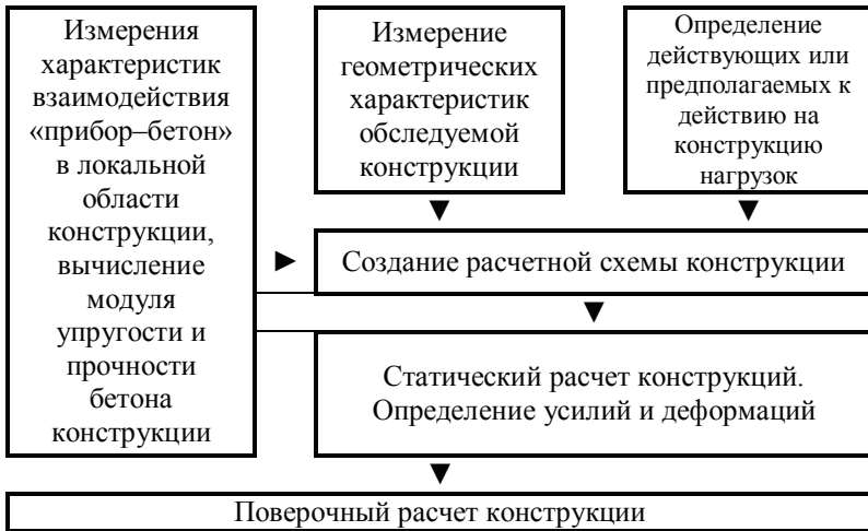
Рис. 1. Схема выполнения операций для осуществления проверочного расчета с использованием результатов определения прочности бетона методами неразрушающего контроля
