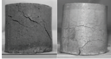
Рис. 2. Общий вид образцов серии 2 (Д-50-КВ-93-ПЧ-07) после 20 лет испытаний в 5% растворе \text{Na}_2\text{SO}_4
