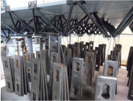
Рис. 4. Вузлове завантаження по нижньому поясу
