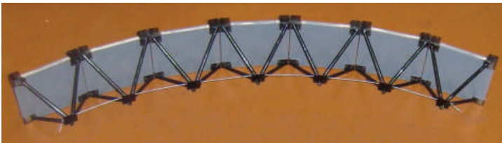
Рис. 1. Збірна аркова секція моделі покриття
