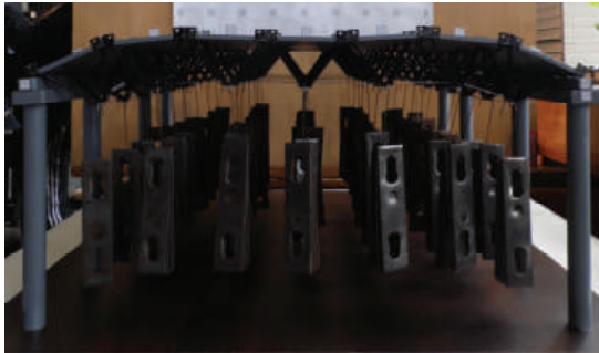
Рис. 5. Деформована схема моделі при повному завантаженні
