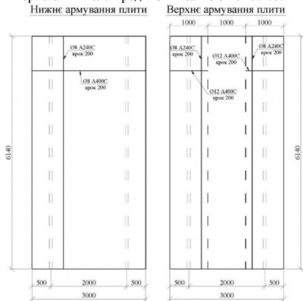
Рис.2. Схема армування плити дослідних зразків
