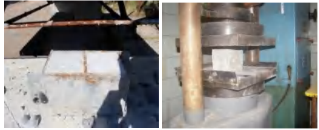
Рис.5. Дослідні бетонні зразки-куби та їх випробування
