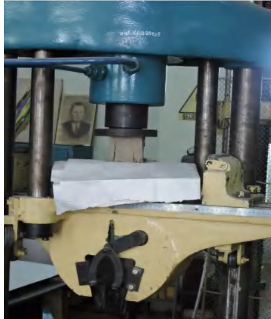
Рис. 2. Испытание образца грунтобетона на прочность при сжатии на гидравлическом прессе УММ-20 / Compressive strength test of soil-concrete sample by means of hydraulic press
