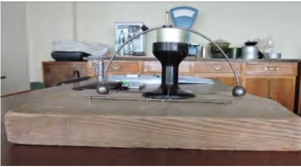
Рис. 1. Определение влажности глинистого грунта на границе текучести при помощи балансного конуса / Determination clay soil moisture on the border of liquid limit by means of balancing cone
