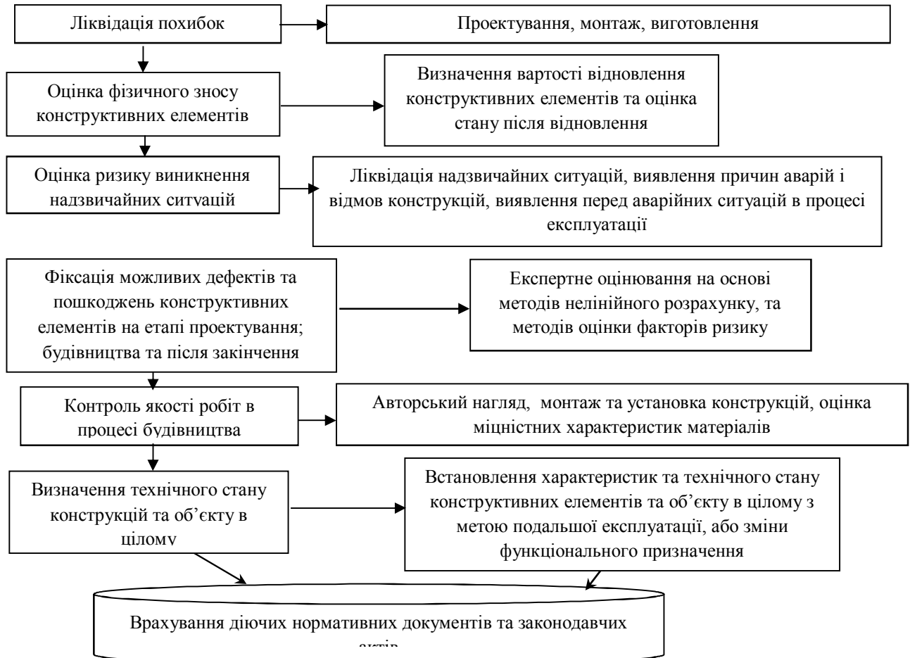
Рис.2. Структурна схема можливих факторів, що можуть призвести до аварійної ситуації / Structural model for possible factors that may cause emergency situation
