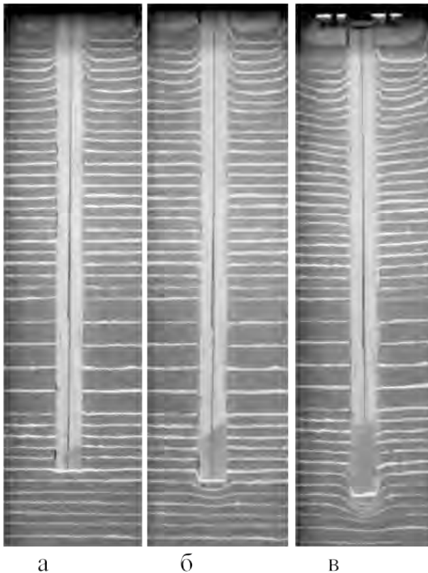
Рис. 7. Деформований стан основи III серії випробувань: а – 1-й етап (навантажувалась плита, нез'єднана з палею); б – 2-й етап (не знімаючи прикладеного навантаження до плити, навантажувалась окремо паля); в – 3-й етап (навантажувалися з'єднанні між собою плита і паля) / Fig. 7. Basis' strained state at the third series of tests: a – 1st stage (plate's fragment not connected with pile was loaded); b – 2nd stage (without taking off the load applied to the plate, pile was loaded separately); c – 3rd stage (interconnected plate's fragment and pile were loaded)
