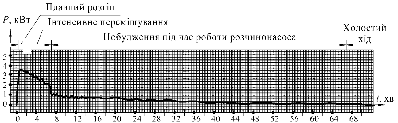
Рис. 3. Удосконалений режим роботи розчинозмішувача штукатурної станції.
