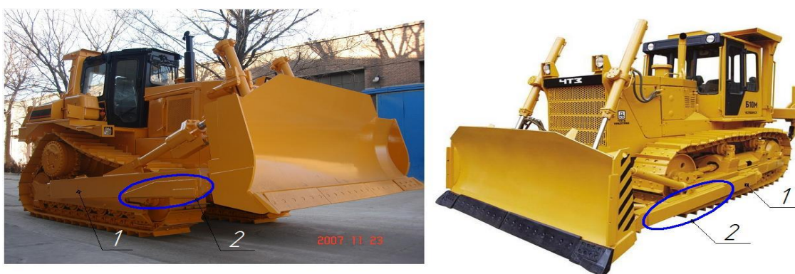
Рис.2. Бульдозеры с увеличенными прочностными характеристиками толкающих брусьев: 1 - толкающий брус; 2 – усиливающие накладки.
