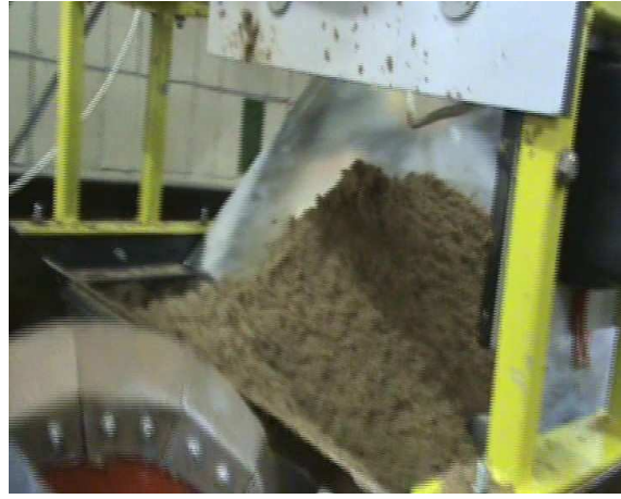
Рис. 7. Копання ґрунта при \alpha_{\text{кож}}=75^\circ .
