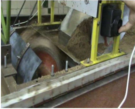
Рис. 7. Копання ґрунта при \alpha_{\text{кож}}=75^\circ .
