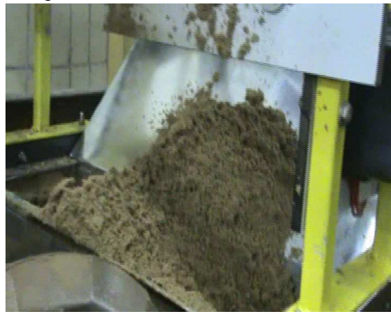
Рис. 6. Копання ґрунта при \alpha_{\text{кож}}=60^\circ .
