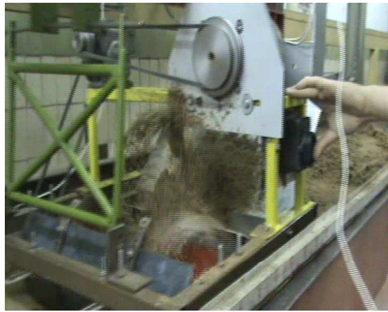
Рис. 5. Копання ґрунта при \alpha_{\text{кож}}=45^\circ .
