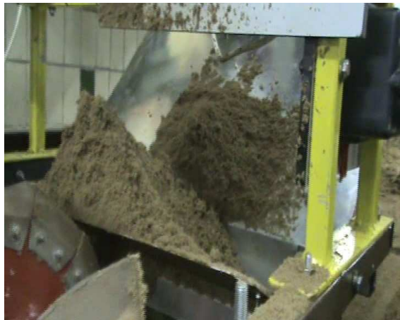
Рис. 5. Копання ґрунта при \alpha_{\text{кож}}=45^\circ .
