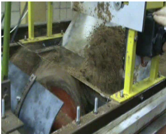
Рис. 6. Копання ґрунта при \alpha_{\text{кож}}=60^\circ .
