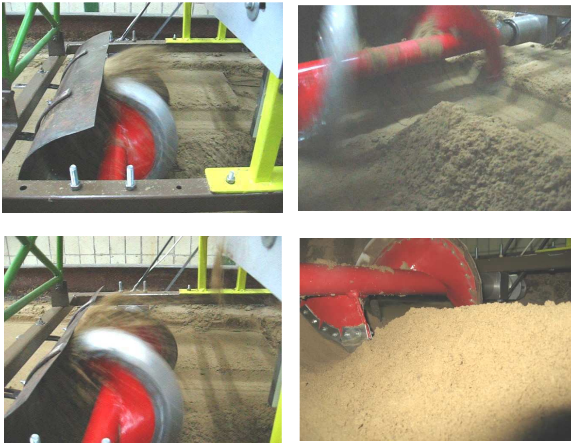
Рис. 3. Копання ґрунта з захисним кожухом.
