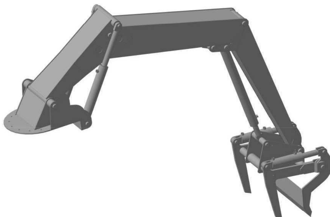
Рис. 1. Разработанные в САПР объёмные модели гидроуправляемого манипуляторного оборудования для укладки бордюрных камней: а – общий вид оборудования на базовой машине; б – общий вид гидроуправляемого манипуляторного оборудования для укладки бордюрных камней.
