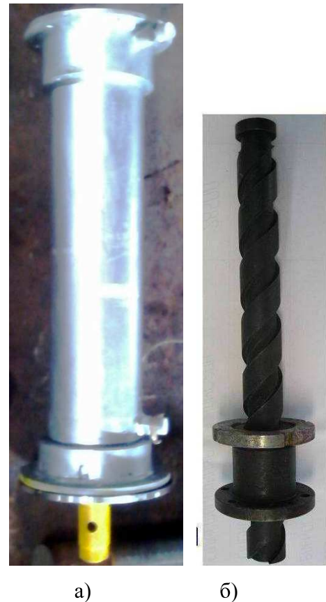
Рис. 3. Привод поступательно-вращательный на базе типового гидроцилиндра: а – общий вид; б - встраиваемая несмазочная винтовая пара.
