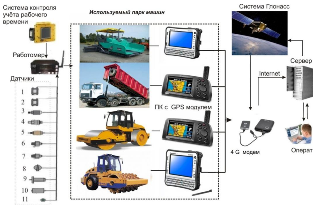
Рис. 1. Контроль оператора за работой используемого парка машин в режиме реального времени с помощью GPS мониторинга; 1 – датчик положения рабочего органа; 2 – датчик количества расходуемого топлива; 3 – датчик учета количества рабочих циклов; 4 – датчик скорости машины; 5 – датчик режима работы двигателя; 6 – датчик работы видео оборудования установленного на машине; 7 – датчик контроля усталости машиниста; 8 – датчик давления масла в гидросистеме; 9 – датчик технологической оснастки типа рабочего органа, 10- датчик сохранения данных при отсутствии покрытия сети, 11-датчик регулирования уровня толщины укладки асфальта (для асфальтоукладчика).
