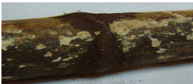
Рис. 14. Разрушение целостности круглой балки под углом \varphi=0^\circ .
