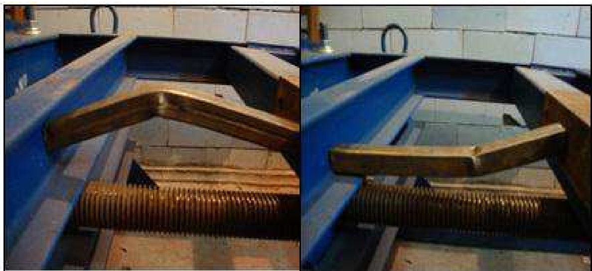
Рис. 10. Деформации торцевой части квадратной балки под углом \varphi=7^\circ при 2 циклах нагружения.
