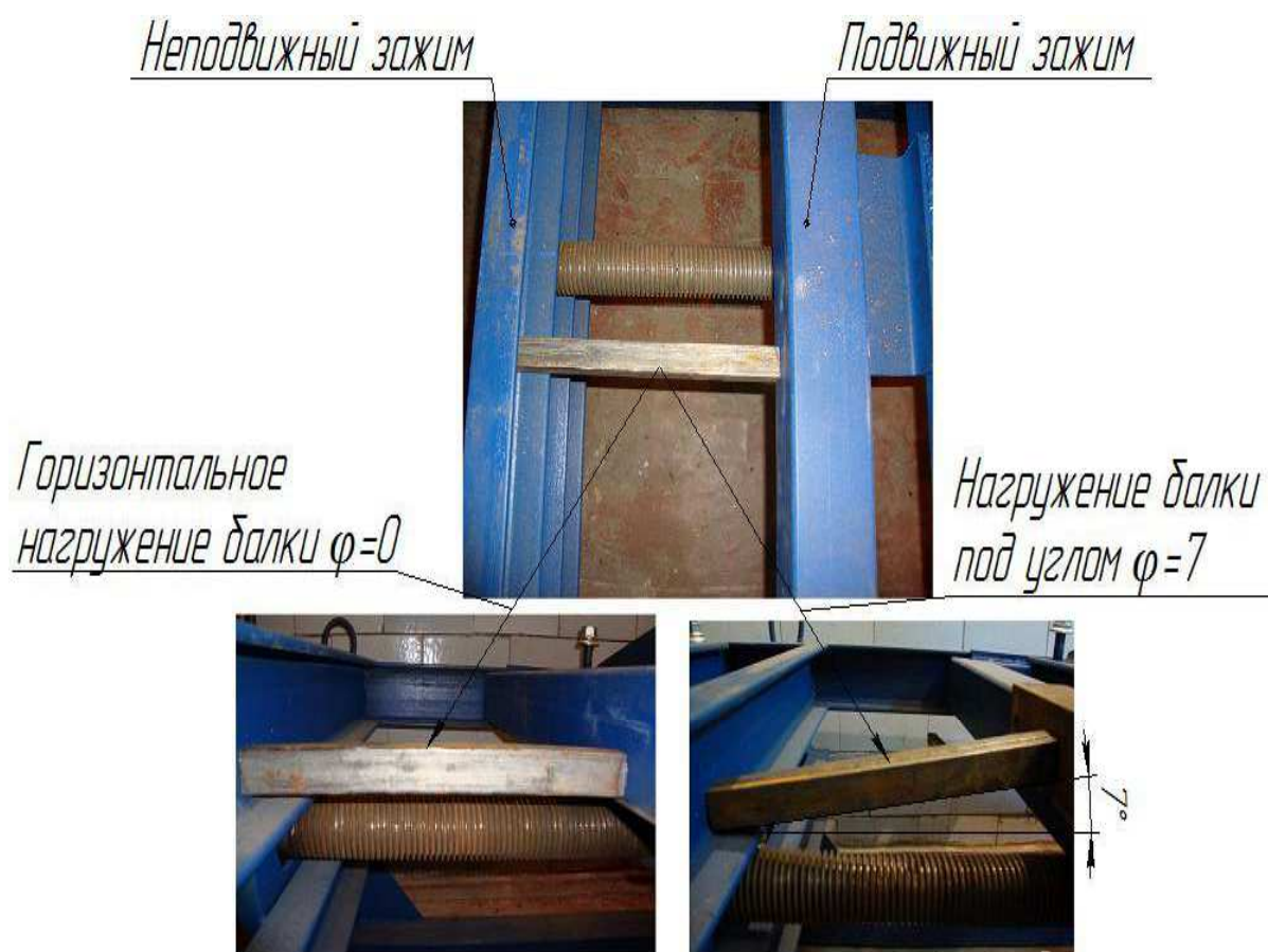
Рис. 4. Схема установки исследуемой балки (схема нагружения балки).
