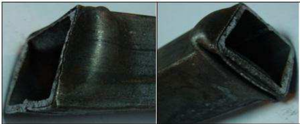
Рис. 10. Деформации торцевой части квадратной балки под углом \varphi=7^\circ при 2 циклах нагружения.
