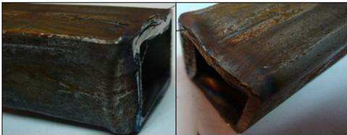
Рис. 7. Деформации торцевой части квадратной балки под углом \varphi=0^\circ при 2 циклах нагружения.
