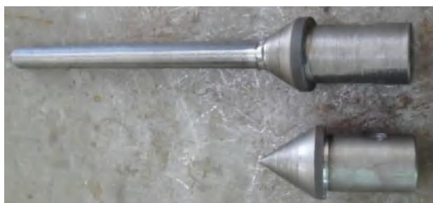
Рис. 3. Измерительный блок: а – схема подключения тензомоста и преобразователя давления к измерительному блоку; б – общий вид переходной муфты и измерительного блока.
