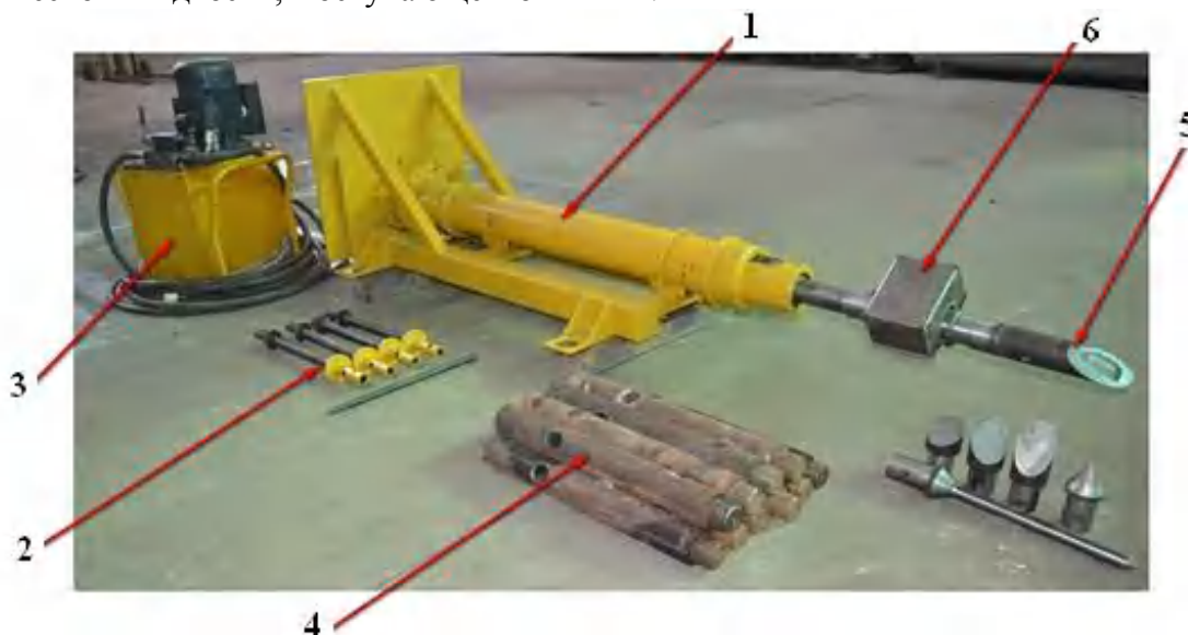
Рис. 1. Экспериментальная установка для исследования процессов прокола грунта: 1 – силовая прокалывающая установка; 2 – винтовые якоря; 3 – гидравлическая станция; 4 – наборные штанги; 5 – прокалывающая головка; 6 – устройство для замера крутящего момента.
