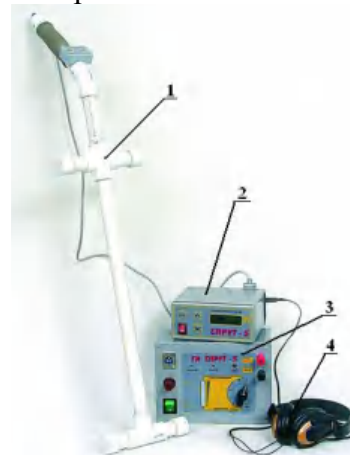
Рис. 5. Общий вид поисковой системы «СПРУТ-5М»: 1 – антенна; 2 – приемник «СПРУТ-5 М»; 3 – генератор импульсов «ГИ СПРУТ-5М»; 4 – наушники.
