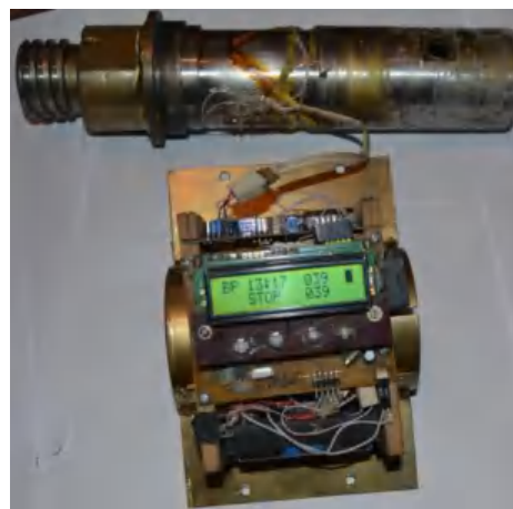
Рис. 3. Измерительный блок: а – схема подключения тензомоста и преобразователя давления к измерительному блоку; б – общий вид переходной муфты и измерительного блока.
