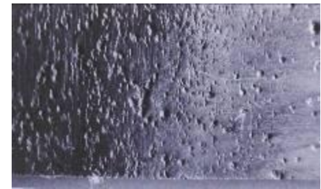
Рис. 1а Руйнування плакуючого шару біметалу 09Г2С+08Х13: а) виразкова корозія днища, \times 5 .
