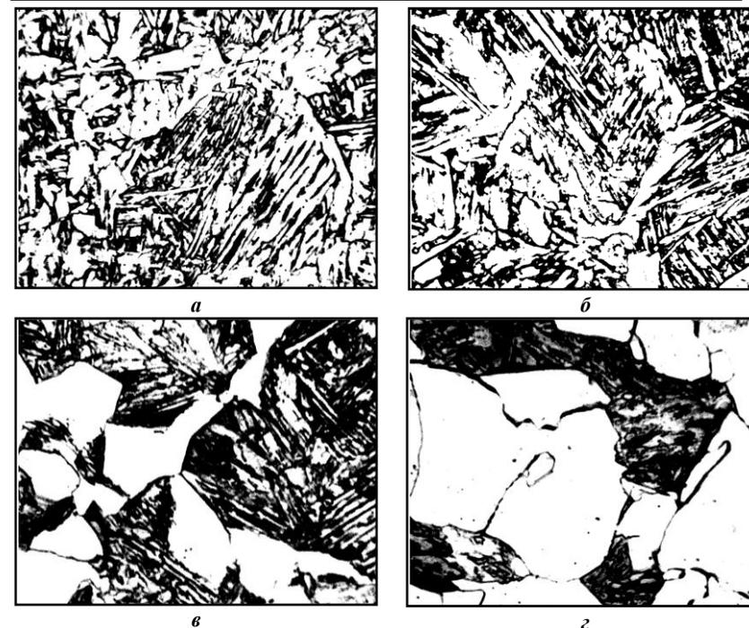
Рис. 6. Структура стали 10Г2ФБ ( $\times 1250$ ) после экспериментальной прокатки, выдержки в течение (с): а – 5; б – 15; в – 120; г – 300 и последующей закалки.
