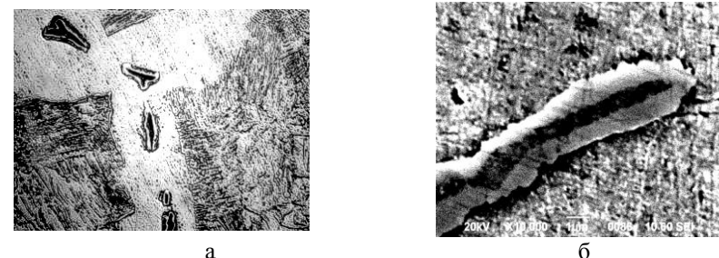
Рис. 1 Микроструктура многофазного включения борсодержащего сплава с содержанием бора 0,09%, углерода 0,5% исходная микроструктура включения а)×1000, б) ×10000,..
