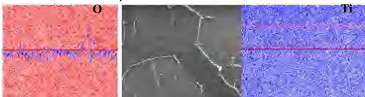
Рисунок 1. Распределение кислорода, введенного по способу № 1, в структуре исследуемого титанового сплава (x4000).
