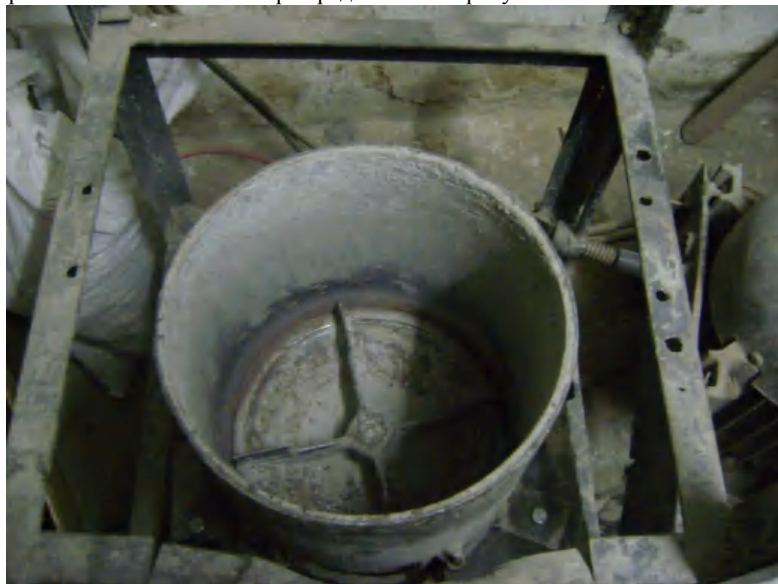
Рис. 1. Общий вид лабораторного смесителя-активатора роторного типа
