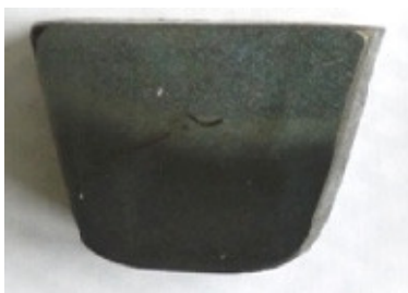
Рис. 2. Внешний вид темплета рельса
