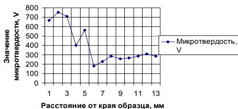
Рис. 3. График изменения микротвердости по сечению образца после электролитно-плазменной обработки
