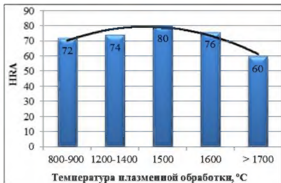
Рис. 2 - Зависимость твердости HRA от температуры плазменной обработки цементованной стали 18XГТ.
