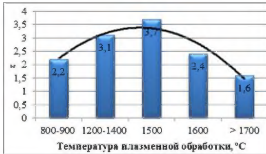
Рис. 4 - Зависимость относительной износостойкости от температуры плазменной обработки цементованной стали 18ХГТ.
