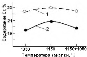
Рис. 5. Изменение содержания хрома в феррите (кр. 1) и аустените (кр. 2) в зависимости от режима термообработки образцов.
