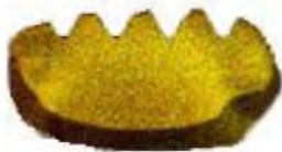
Рис. 2. Макроструктура гайки М8 из ТМУ катанки стали марки 20Г2
