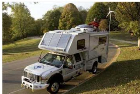
Рис.3. Автодом с ветрогенератором и солнечной энергоустановкой / Fig. 3 Caravan with wind turbines and solar power plant.
