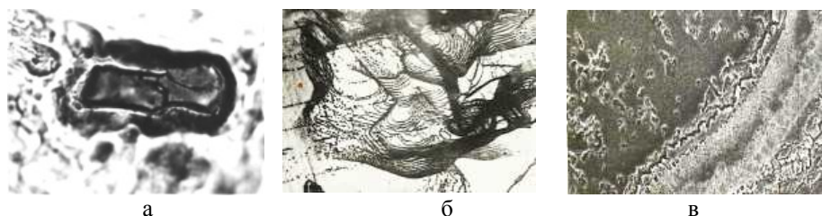
Рис. 1. Проскальзывание вдоль границ включение-матрица после лазерного воздействия (а) и включений в стальной матрице (б, в): а - 1000 °С, б - 25 °С, в – 600 °С
