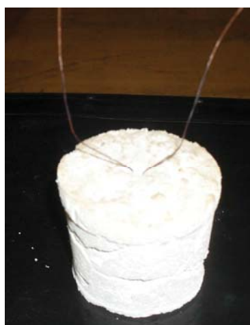
1 – образец, 2 – шпур, 3 – разрядник с сосредоточенным зарядом, 4 – разрядник с рассредоточенным зарядом, 5 – забойка
