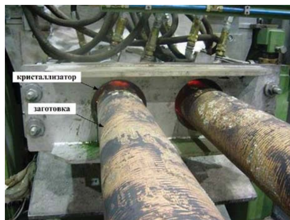
Рисунок 1 – Отливка круглых заготовок на установке горизонтального непрерывного литья
