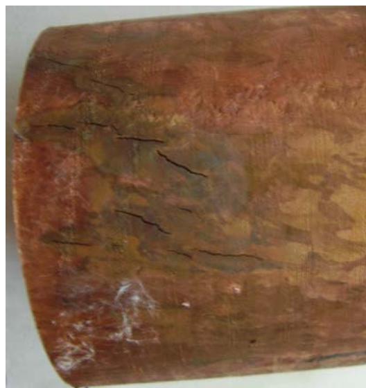
Рисунок 3 – Продольные межкристаллитные трещины на поверхности экспериментальной трубной заготовки
