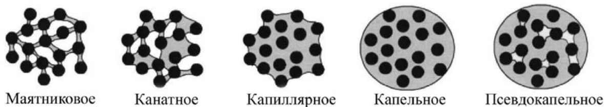
Рисунок 5 – Различные стадии насыщения пор жидкостью
