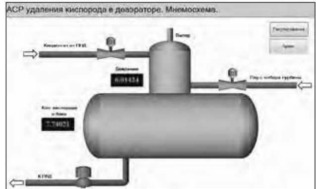
Рис. 3. Мнемосхема объекта автоматизации
