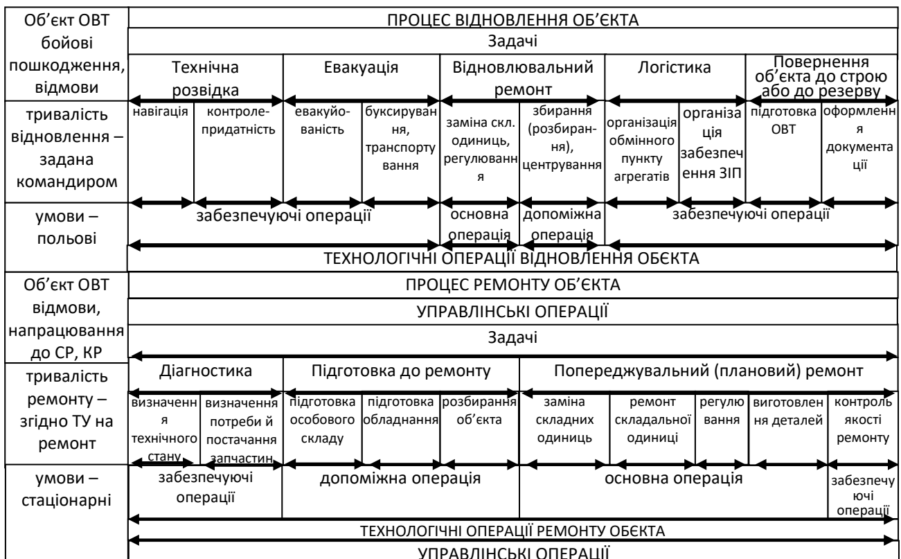
Рис. 1. Системний обрис процесів відновлення та ремонту ОВТ за типовими операціями.
